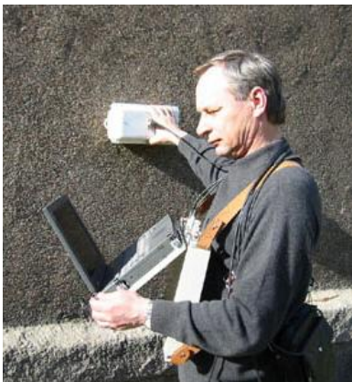
2G 天线探测墙壁内部的金属保险箱
